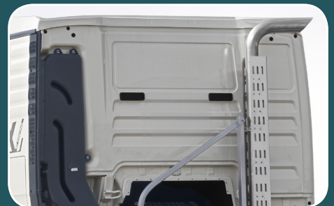
مدخل هواء مرتفع Raised Air Intake
