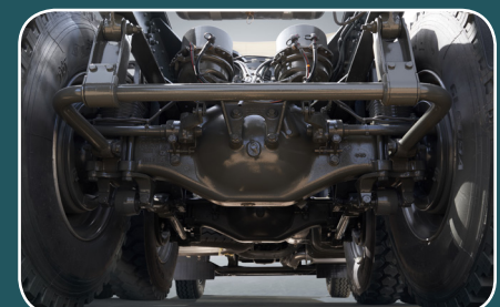
المحور الخلفي مع المثبت Rear Axle with Stabiliser
